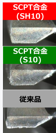
図2 刃先の様子 (1300穴加工後)
